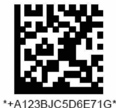
图 6 HIBCC Data Matrix 条码示例
