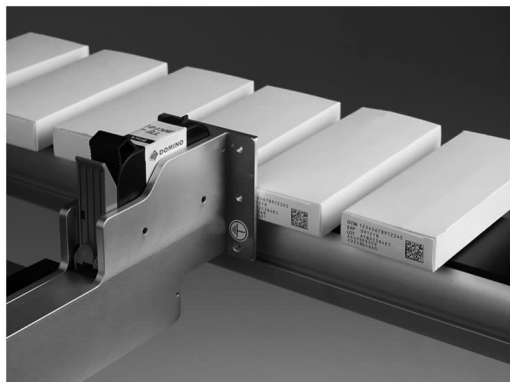
图9 热发泡喷码技术在外纸盒及特卫强上进行UDI赋码
