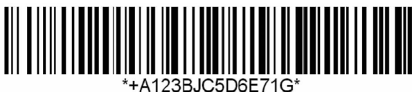
图 5 HIBCC Code-128 条码示例
