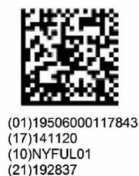
图3 GS1 Data Matrix 条码示例
