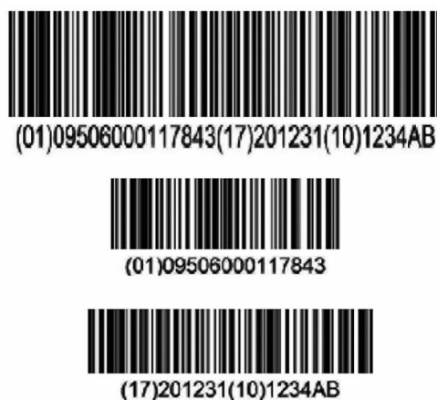
图2 GS-128 条码串联和并联示例
